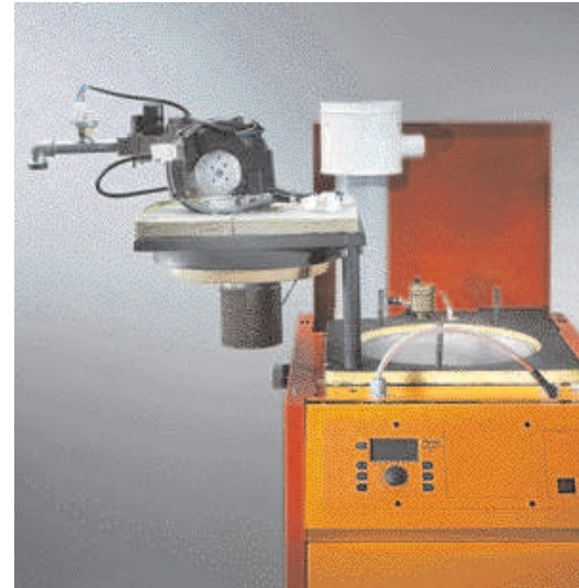
Suportul pentru arzatorul rabatabil permite realizarea mai usoara a verificarilor si a intretinerii
